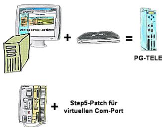
Sie setzen die Geräte der Tele-Network-Familie ein und wollen kein Gerät auf dem Tisch stehen haben? Kein Problem, installieren Sie sich die WinTELEPROF-Software auf Ihrem PC und über einen virtuellen COM-Port greifen Sie nach erfolgtem Verbindungsaufbau mit Ihrer Step5/7-Programmiersoftware (auch Siemens) zu.
