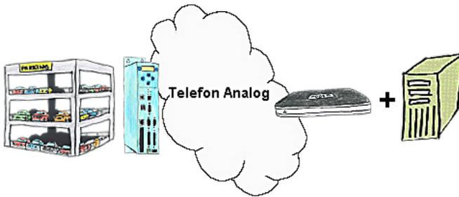
Ihr Parkhaus bzw. die Steuerung sendet Ihnen die Belegung / Auslastung auf einen PC mit Modem, so dass Sie die Daten zur Weiterverarbeitung verwenden können.
