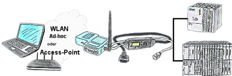
Sie befinden sich vor Ort an Ihrer Anlage und sollten sich um die Maschine bewegen und gleichzeitig steuern/beobachten. Kein Problem, Sie parametrieren die S7-WLAN-Bridge, schließen das MPI-LAN an und verbinden sich mit einem Access-Point vor Ort oder mit dem Ad-hoc-Netzwerk Ihres Laptops und sind ONLINE auf der Steuerung.
