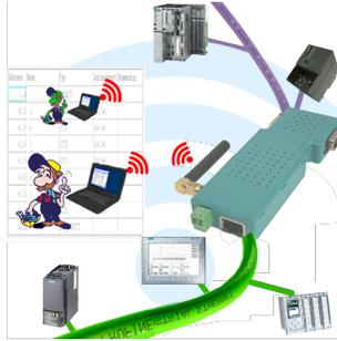
Kommunikation kabelgebunden oder auch kabellos (WIFI) über den selben Adapter mit der jeweiligen Steuerung
