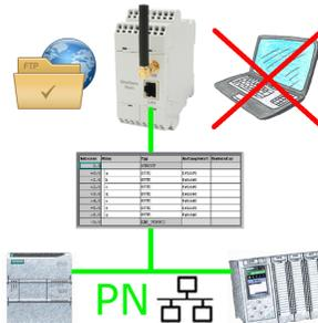
S7-SPS getriggerte DB-Sicherung/-Wiederherstellung ohne zusätzlichen PC über PN-Port
