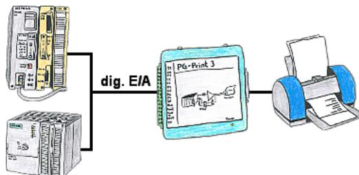
Sie benötigen Produktionsdaten, Lauflisten Ihrer Anlage, möchten aber keinen CP einsetzen oder bekommen keinen seriellen Drucker mehr? Kein Problem, sie benötigen von der Steuerung 8 dig. Ausgänge und 3 dig. Eingänge um den PG-Print anzuschließen und Sie können sofort mit einem EPSON- oder HP-kompatiblen Parallel-Drucker diese Listen generieren.
