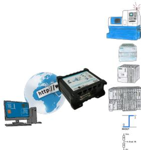
Fernzugriff auf all Ihre Anlagen, SPSen ohne großen Aufwand. Selbst Auslösen von Aktionen durch Setzen der integrierten digitalen Ausgänge oder das Einlesen der digitalen und analogen Eingänge ist über die Internet-Kopplung möglich.
