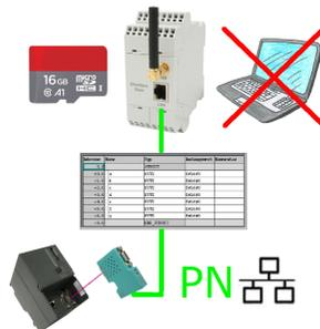
S7-SPS getriggerte DB-Sicherung/-Wiederherstellung ohne zusätzlichen PC über MPI/Profibus auf SD-Karte
