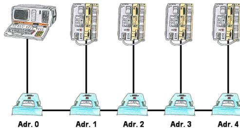
Sie müssen mehrere S5-Steuerungen so vernetzen, dass Sie zentral alle Steuerungen im Bedarfsfall ansprechen können und das Ganze ohne Änderung des SPS-Programms? Kein Problem, Sie schließen an alle in Frage kommenden Steuerungen die IBX-Klemme an, stellen in der Klemme die jeweilige Adresse (1 bis 30) ein und über die Klemme mit der Adresse 0 können Sie alle Steuerungen über die PG-Bus-Pfadanwahl ansprechen.
