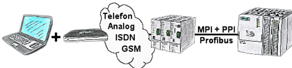
Der Zugriff mit der TS-Software von Siemens oder PG-2000 mit TS-Option auf die angeschlossene SPS-Steuerung erfolgt mittels einer Kopplung über Analog-, ISDN- sowie über GSM-Strecke.
