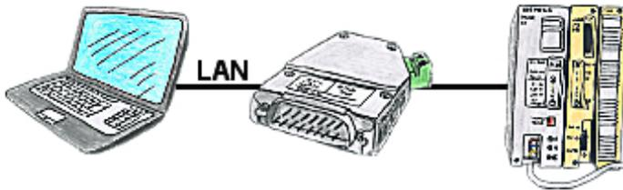
Sie möchten Ihre S5-SPS-Steuerung über LAN ansprechen, aber keinen Ethernet-CP integrieren? Kein Problem, stecken Sie das S5-LAN++ auf die PG-Schnittstelle und greifen per LAN zu.
