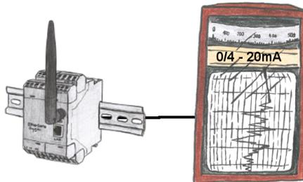
Durch den Anschluss eines Linienschreibers an das EtherSens-Gerät kann jeder ohne Netzwerk-Kenntnisse den Log optisch erfassen und weiter verarbeiten.
