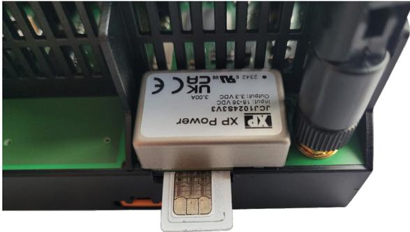
Die SIM-Karte mit Gefühl einschieben bis ein Widerstand zu spüren ist, lässt man die Karte los hört man ein leises Klicken. Zum Auslösen wird die SIM-Karte wieder reingedrückt bis zum Widerstand und los gelassen. Die Karte wird ausgeworfen.
