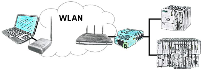
Sie befinden sich vor Ort an Ihrer Anlage und sollten sich um die Maschine bewegen und gleichzeitig steuern/beobachten. WLAN ist vorhanden, aber ihr PC bietet keine WLAN-Unterstützung. Kein Problem, Sie parametrieren ALF als Client und schließen an ihm ihren PC an und verbinden sich mit dem vorhandenen WLAN und sind online auf der Steuerung.
