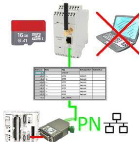
S5-SPS getriggerte DB-Sicherung/-Wiederherstellung ohne zusätzlichen PC über PG-Buchse und Ethernet auf SD-Karte
