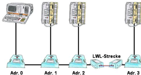
Sie benötigen größere Strecken für Ihren L1-Bus als die zulässigen 1200m? Sie haben auf Ihrem jetzigen L1-BUS massive Störungen? Sie benötigen eine serielle Strecke über größere Entfernungen und das ganze galvanisch entkoppelt? Kein Problem, all diese Probleme sind durch die LWL-Adapter lösbar. Die Adapter gibt es für Kunststoffaser und Glasfaser, für L1-BUS und RS232.
