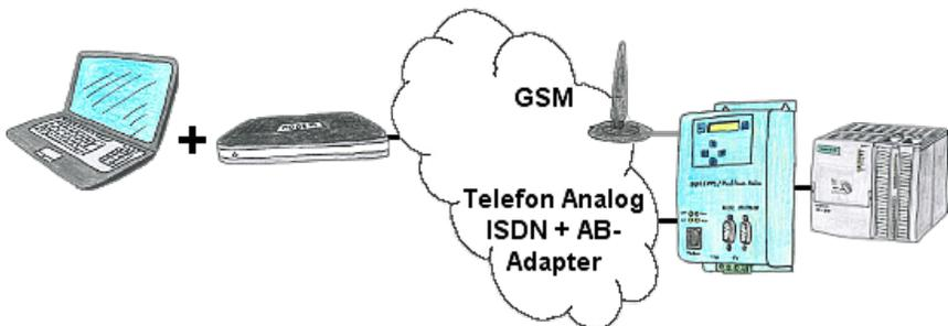
Der Zugriff mit der TS-Software von Siemens oder PG-2000 mit TS-Option auf die angeschlossene SPS-Steuerung erfolgt mittels einer Kopplung über Analog-, ISDN- (nur mit AB-Adapter)sowie über GSM-Strecke.
