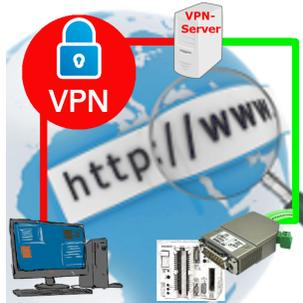
Fernwartung einer Siemens-S5-Steuerung mit S5-LAN++ an PG-Schnittstelle über separaten VPN-Server
