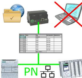
S7-SPS getriggerte DB-Sicherung/-Wiederherstellung ohne zusätzlichen PC über PN-Port
