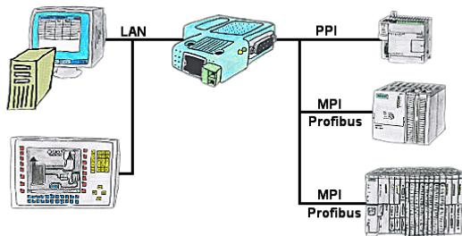
Ihr Panel hat als SPS-Schnittstelle nur eine LAN-Buchse? Kein Problem, verbinden Sie diese Buchse mit dem S7-LAN oder dem MPI-LAN-Kabel und stecken dieses direkt auf den PPI/MPI/Profibus der Steuerung. Schon steht Ihnen der Zugriff auf die Variablen und Daten der Steuerung zur Verfügung.
