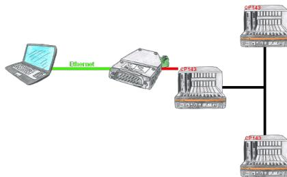
Mit dem S5-H1-PG-LAN sind Sie in der Lage die H1-Pfadanwahl über das S5-LAN++ zu tätigen und mit sämtlichen Steuerungen im H1-Bus zu kommunizieren. Sie müssen nicht mehr seriell an den CP, sondern lösen das ganz einfach über Ihr Netzwerk.
