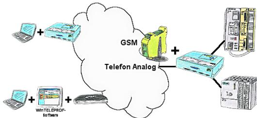
Der Zugriff auf die angeschlossene SPS-Steuerung erfolgt mittels einer Kopplung über Analog-, ISDN- (mit AB-Adapter), sowie über GSM-Strecke (mit ext. GSM-Modem).
