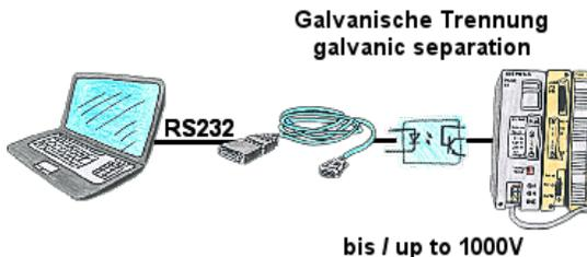
S5-SPS-Kommunikation, hochwertiger PC und Angst um Schnittstellen, unsicher ob SPS geerdet ist oder SPS steht in unsafer Umgebung. Galvanische Trennung ist die praktikabelste Lösung. "PG-ISO-Set" (PG-UNI-Kabel + PG-ISO-Adapter) trennt die Kopplung zur angeschlossenen S5-SPS galvanisch, bietet Schutz des PCs bis zu einem Spannungsunterschied von 1000V.
