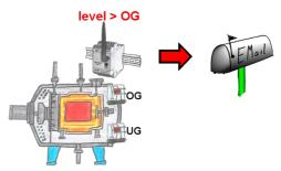
Überwachen Sie Prozesse und bei Erreichen einer vorgegebenen Ober-/Untergrenze benötigen Sie eine Meldung? Dann aktivieren Sie im Gerät die Grenzwert-Überwachung und Sie bekommen diese Meldung. Des weiteren sendet Ihnen das Gerät auch seinen Zustand und Sie sind immer auf dem Laufenden.
