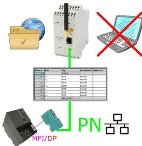
S7-SPS getriggerte DB-Sicherung/-Wiederherstellung ohne zusätzlichen PC über MPI/Profibus auf FTP-Server
