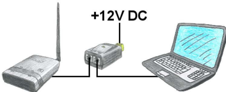
Sie wollen ALF nicht über die 24V DC versorgen und haben bereits in Ihrem Netzwerk PoE "Power over Ethernet" im Einsatz. Kein Problem, ALF unterstützt passives PoE, das heißt er kann über die nicht belegten Leitungen des LAN-Kabels mit 12V DC versorgt werden. So brauchen Sie ihn nicht zusätzlich mit den 24V DC versorgen.
