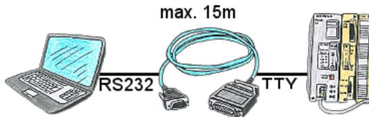
S5-SPS-Kommunikation von PC mit seriellem COM-Port und Ihrem Programmierpaket? PG-COM-Kabel bis zu einer Länge von 15m sind das passende Interface-Produkt. Ohne spezielles Zubehör, ohne externe Versorgung, an PC und S5-SPS angesteckt und sofort arbeiten. Anschluß mit original Siemens Schieberverrieglung an S5-SPS, mit Schraubbolzen am PC. Funktion mit S5-90U bis S5-155U. Anschluss SPS-Seite 15polig, PC 9polig (Anpassung auf 25polig jederzeit möglich).
