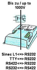
Koppeln von 2 Geräten mit unterschiedlichen Hardware-Schnittstellen?
