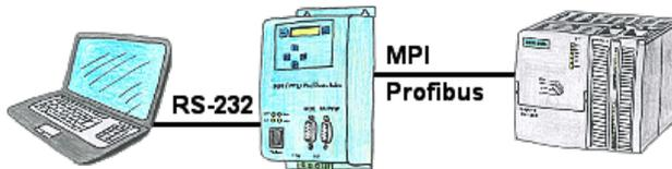
Über das MPI/PPI/Profibus-Modem können Sie sich direkt mit Ihrem PC/Laptop seriell anbinden und somit ohne einen PC-Adapter oder sonstige S7-Programmierskabel direkt mit der Steuerung kommunizieren.
