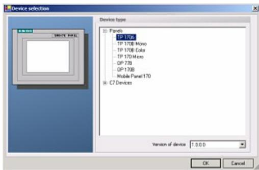
3. In the „Device selection“ mark the used operator panel (example: „TP 170A“)
