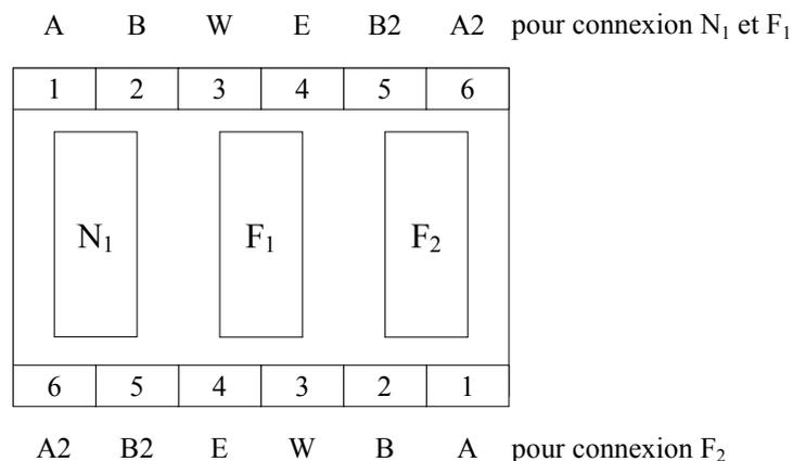
Les connexions A + B suffisent pour la connexion du modem, sans appareils téléphoniques.
