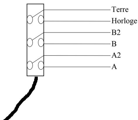
Vue de dessus sur le connecteur équipement de connexion de télécommunications (de devant)
