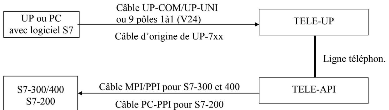
La vitesse de transmission est réglée sur **19200 bauds** pour cette option. Vous pouvez à l'aide de votre UP Siemens ou votre PC compatible établir la liaison avec l'appareil TELE-Network réglé en tant que TELE-UP par l'intermédiaire de V.24 ou V.24/TTY.
